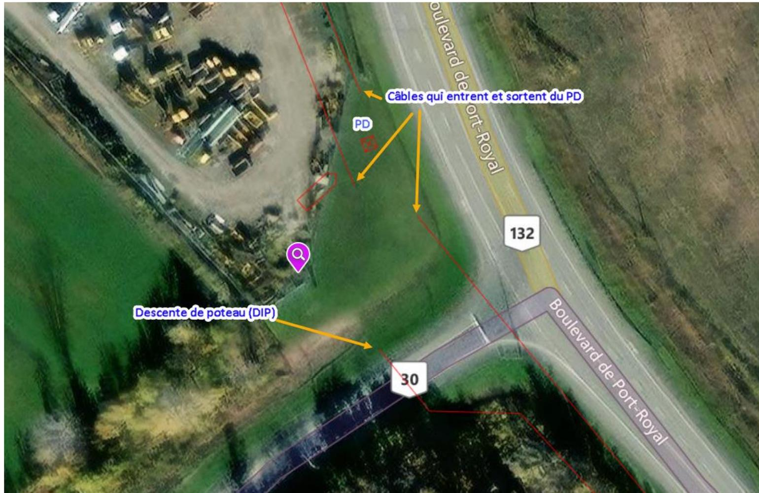
Prendre note que **les carrés rouges avec un X** peuvent aussi représenter un **PD**, un **PA**, un **PD Lampadaire** de Cogeco ou d'une autre compagnie. **Voir procédure < réseau dans conduits autrui >**.
